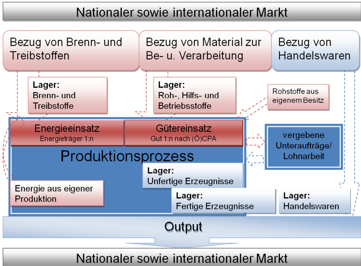
Abbildung 1: Schematische Darstellung des Güter- und Energieeinsatzes im betrieblichen Produktionsprozess
